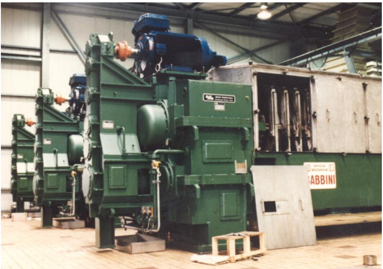
6 Getriebekombinationen DP32-D mit direktgekoppeltem Motor und Sicherheitskupplung 6 gearbox combinations DP32-D with directly connected motor and safety coupling
